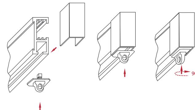
\*Установить стопор: с усилием нажмите на пластиковую часть стопора и, не отпуская, поверните на 90°
