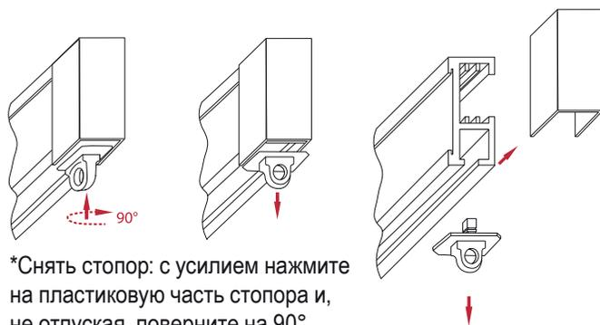
\*Снять стопор: с усилием нажмите на пластиковую часть стопора и, не отпуская, поверните на 90°
